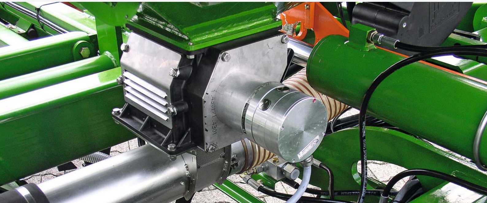
Entraînement de dosage électrique précis
