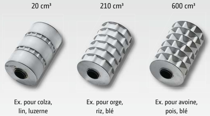
Bobines de dosage pour différentes semences
