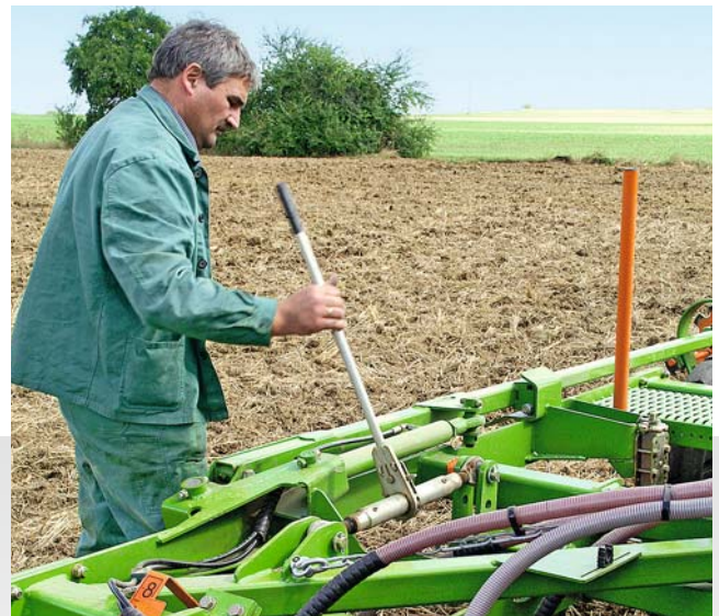
Réglage de base de la profondeur de semis
